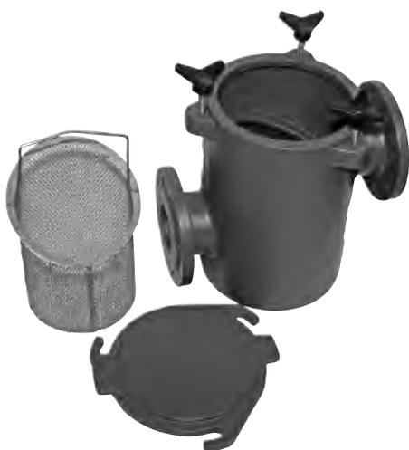
Новая серия чугунных фильтров предварительной очистки, соответствующих стандарту DIN 2501, с диаметрами соединительных элементов от DN 65 до DN 200. В зависимости от модели оснащены 3 или 4 стяжными ручками для обеспечения идеального уплотнения пробки. Резервуар и пробка фильтра предварительной очистки из чугуна, кассета – из нержавеющей стали марки AISI 316.
